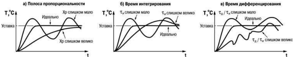
Рисунок Г.3 – Примеры графиков переходной функции
